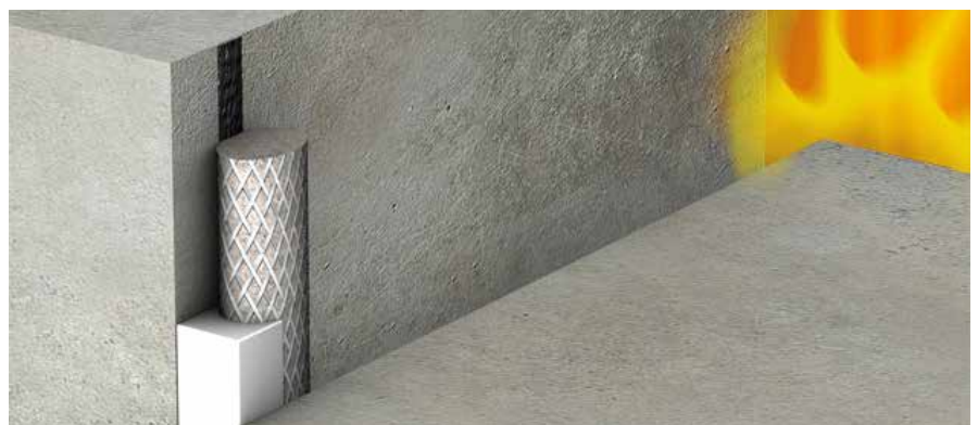
Junta horizontal en contacto con una pared (H)
