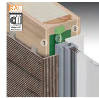
1 Fugendichtungsfolie mit Fensterfolienkleber 2 Schaum 3 Fugendichtungsfolie mit Fensterfolienkleber
