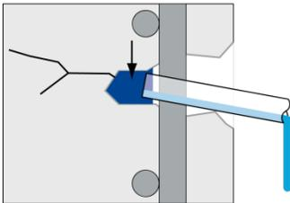
Fehlstelle mit **VANDEX WASSERSTOPPER** vordichten.
