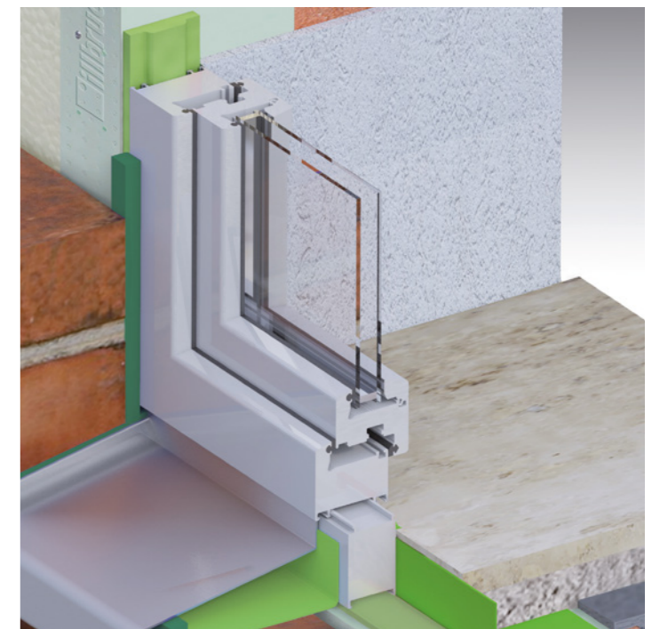
Abdichtung der Fensteranschlussfuge zum Beispiel mit Multifunktionsband
