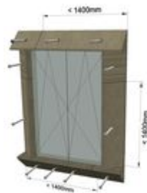
Ilustracja 7: Wkręty zabezpieczające - okno balkonowe.
