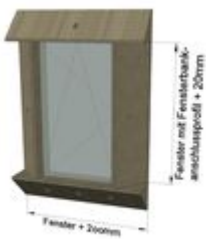
Ilustracja 4: Wymiary przecięcia profilu instalacyjnego dla 10 mm spoiny
