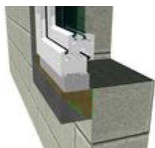
Imaginea 1: cadru de instalare pentru fereastră illbruck PR007 complet asamblat cu piesă izolatoare illbruck PR008
