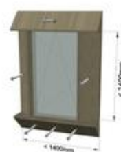
Imaginea 5: Șuruburi de prindere 1 canat
