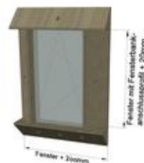
Imaginea 4: Dimensiunile cadrului tăiat pentru un rost de 10 mm
