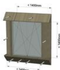
Imaginea 6: Șuruburi de prindere 2 canaturi
