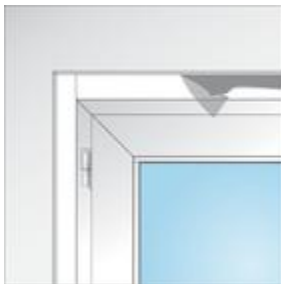
Bild 4: Die Leisten werden stumpf gestoßen.
