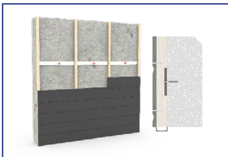
Jellemző részlet a Hardie VL Plank és egyéb általános időjárásálló deszkák mögött
