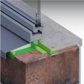
Lösungsmöglichkeit: Innen: ME500 TwinAktiv EW mit SP025 Fensterfolienkleber Öko I Mitte: FM210 Fensterschaum I Außen: TP600 illmod 600, ME500 TwinAktiv EW mit SP025 Fensterfolienkleber Öko, SP525 Hochbaufugen-Dichtstoff mit PR102 PE-Rundschnur
