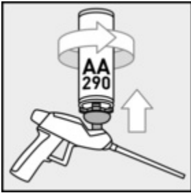
Reinigungsbild 6: Pistolenreiniger von der Pistole abschrauben
