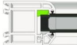
Bild 1: Kraftschlüssige aber nicht starre Verklebung von Isolierglas in Flügelrahmen
