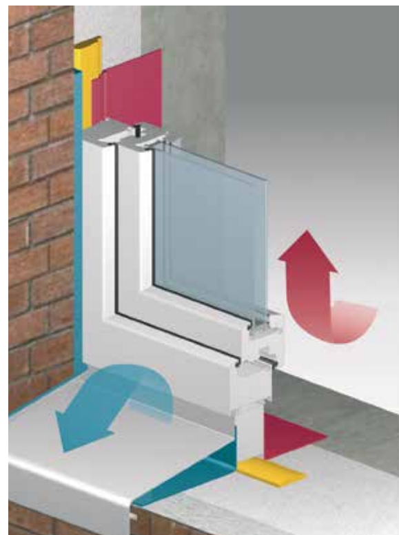
Principio físico del sistema i3 con 3 productos.
