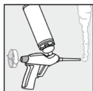
3. Austrittsmenge durch Betätigen der Dosierschraube einstellen und den Schaum im Strangverfahren verarbeiten
