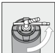
3. AA210 um 90 Grad in Uhrzeigerrichtung drehen
