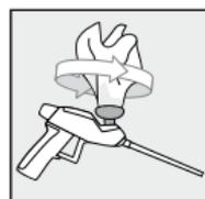
7. Das Ventil der Pistole wiederholt mit einem sauberen Tuch reinigen
