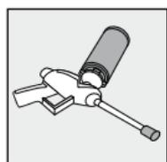
5. Dose für kurze Pausen mit anschließender Weiterverarbeitung auf der Pistole belassen und die Düse schließen (stehend auf der Dose lagern)
