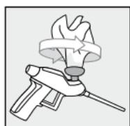
2. Das Ventil der Pistole mit einem sauberen Tuch reinigen
