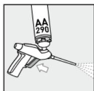
4. Abzugshebel betätigen, bis der Reiniger durch die Düse sprüht
