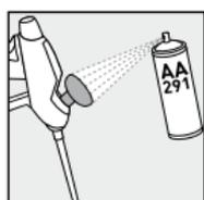
1. Das Ventil der Pistole mit dem Pistolenreiniger besprühen
