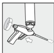
2. Abzugshebel und Dosierschraube an der Pistole betätigen
