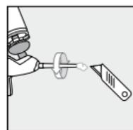
7. Ausgehärtete Schaumüberstände mit einem Cuttermesser entfernen
