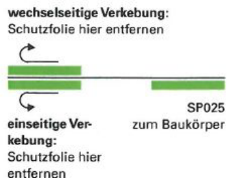
Foto 12: EW + / EW = pe o parte și alternativ: autoadezivul poate fi utilizat atât alternativ, cât și pe una dintre părți, în funcție de partea de pe care se îndepărtează protecția autoadezivului.
