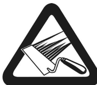
Foto 15: Semnificația simbolului = parte tencuibilă Suprafețe de montare la perete pentru lipire Suprafețele adezive trebuie să fie uscate și lipsite de ulei, grăsimi, praf și alte componente antiadezive. Combinația de benzi autoadezive cu etanșanți care nu fac parte din sistemul illbruck poate duce la diverse interacțiuni. Compatibilitatea trebuie verificată în detaliu. Informații de bază despre tencuirea foliilor se regăsesc în prospectul informativ „Tencuirea foliilor pentru prinderea ferestrelor; Fișă tehnică Asociația federală a industriei de gips e.V. : Grup industrial gips de construcție”. Trebuie să efectuați propriile teste cu privire la aderența diferitelor tencuieli. În cazul unor rezultate nesatisfăcătoare, montarea pe perete cu plasă este întotdeauna preferabilă.
