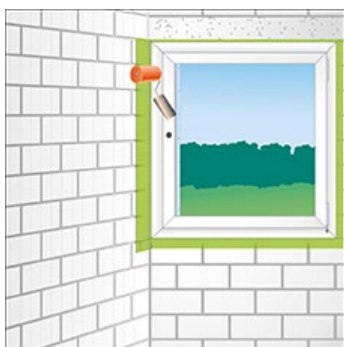
Foto 5: rulați pe folie cu o rolă de presiune
