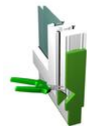
Bild 1: Abdichtung aussparen
