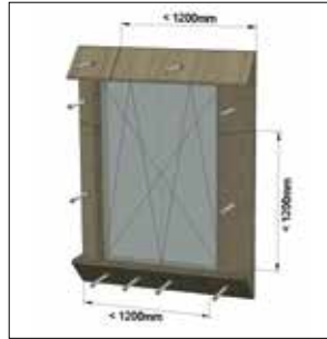
Abb. 4: Sicherungsschrauben BLK-Tür
