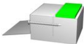
Bild 2: optimaler unterer Fensteranschluss mit dem PR013 Anschlussprofil
