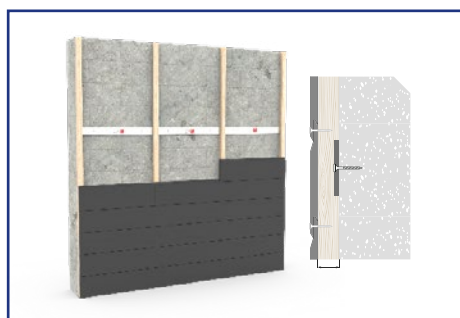
Detaliu tipic din spatele Hardie VL Plank și alte plăci similare.
