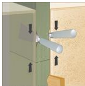
Bild 2: Stumpfstoß im Massivbau
