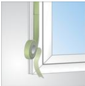
Bild 3: Stumpfstoß bei der Fenstermontage
