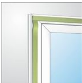
Imaginea 1: Cum să lipiţi banda de etanşare la instalarea ferestrei.
